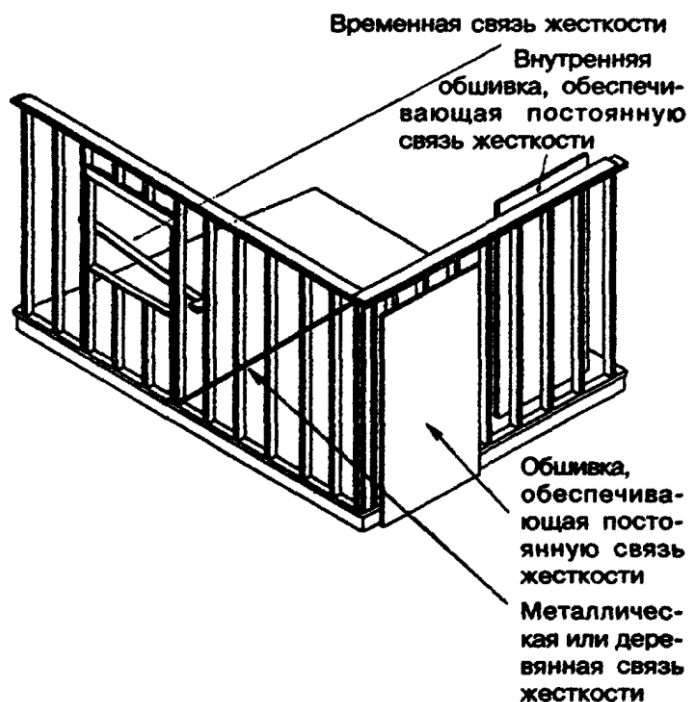
Рисунок 7-1 — Каркас стены
