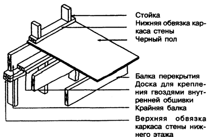
Рисунок 7-4 — Деталь установки доски для крепления внутренней обшивки
